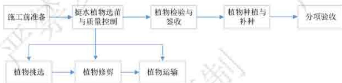
图 2-19 沉水植物种植工艺流程图
